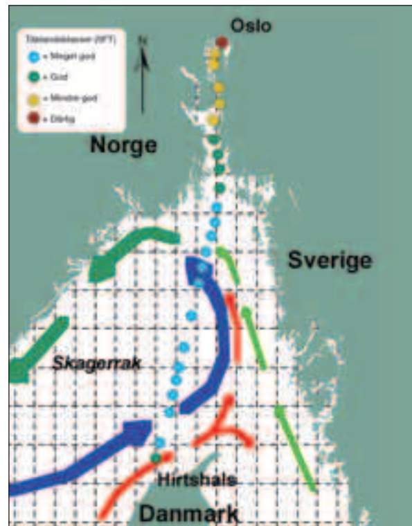
Figur 5. Observasjoner av nitrat+nitritt tatt med det automatiske overvåkingssystemet ombord på fergen "Color Festival" mellom Oslo og Hirtshals vinteren 2003/2004. Tilstanden er vurdert ut fra SFT's klassifiseringssystem for overgjødning i fjorder og kystfarvann. Klassifisering baserer seg på mellom 6 (gjelder de fleste stasjonene) og 18 observasjoner (et utvalg av stasjonene).
