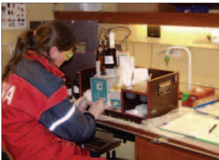
Oksygenanalyser gjennomføres ombord på forskningsfartøyet "T.Braarud". Her titrerer forskningsassistent Merete Schøyen oksygen i båtens laboratorie. (Foto Jahn Trondsen)
