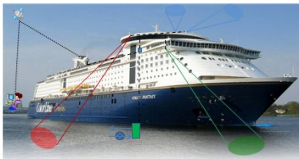
Figur 2. MS Color Fantasy illustrert med dekkensensorer for lys (blå), havfarge (grønn), overflatetemperatur (rød), kommunikasjon til land og FerryBox systemet omtrentlig plassering i fartøyet.
