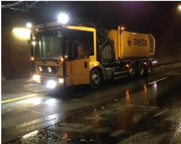
Spylebil som benyttes ved tunnelvask
