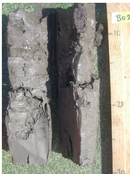
Fig. 19. Replikatkjerne splittet på dekk like etter prøvetakning. De øverste 6 cm mangler på bildet, da disse er tatt ut for videre foraminiferanalyser.
