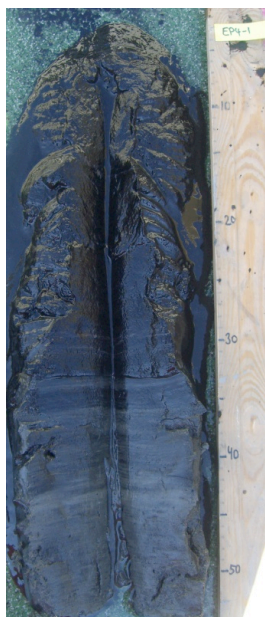
Fig. 4. Replikatkjerne splittet på dekk like etter prøvetakning. De øverste 6 cm mangler på bildet, da disse er tatt ut for videre foraminiferanalyser.
