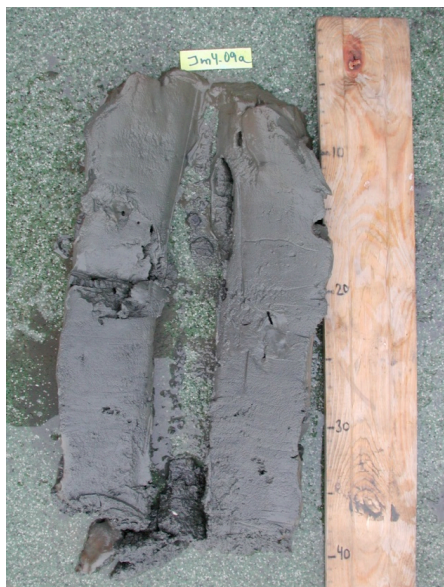
Fig. 21. Replikatkjerne splittet på dekk like etter prøvetaking. De øverste 6 cm mangler på bildet, da disse er tatt ut for videre foraminiferanalyser.
