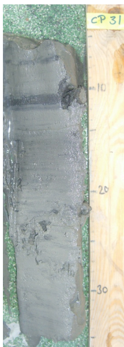
Fig. 7. Replikatkjerne splittet på dekk like etter prøvetakning. De øverste 6 cm mangler på bildet.
