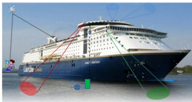
Figur 213. MS Color Fantasy illustrert med dekkssensorer for lys (blå), havfarge (grønn), overflatetemperatur (rød), kommunikasjon til land og FerryBox systemet omtrentlig plassering i fartøyet.
