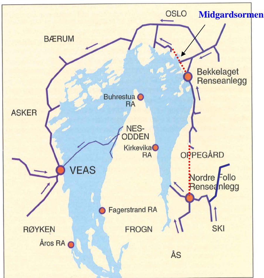
Figur 16. Forslagsvis plassering av ny tunnel for å koble tunnelsystemet sørøst i regionen med hovedledningsnettets nord og vest i regionen. Midgardsormen er også vist på kartet.
