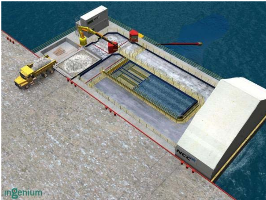
Figur 18. Fra Teknisk Ukeblad 21.10.2009. LEKTER: Betonglekteren måler 25x50 meter og smelter og renser snøen i flere trinn. Nå gjenstår kun mindre justeringer og tillatelser før bygging kan starte. NCC har fått tilsagn om plass på Akershuskaia. Foto: NCC
