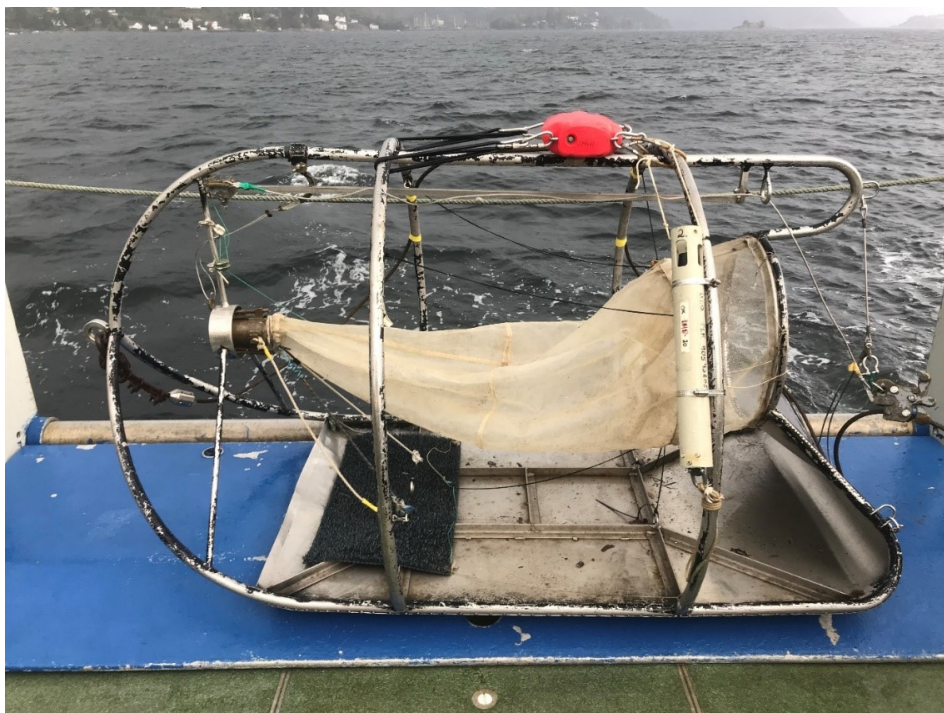
Figur 57. Beyer-sleden som ble brukt for prøvetaking av hyperbentos (reker) på lokalitetene i Indre Oslofjord i 2024. Foto: NIVA
